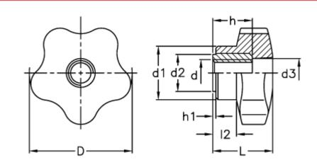
= 70 l2 = 21 D d1 = 30 d2 = 17 d3 = 17 d 6H = M12= 26 h = 1.5 h1 = 45 L
